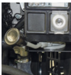
RPM manual regulator Regulador manual de revoluciones motor
